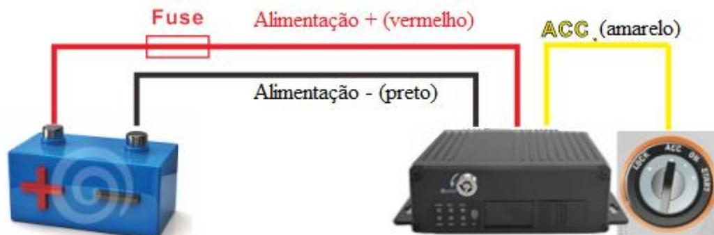
Conecte o polo positivo da bateria no cabo positivo do MDVR (cabo vermelho), em seguida faça o mesmo com o polo negativo da bateria (cabo preto).
