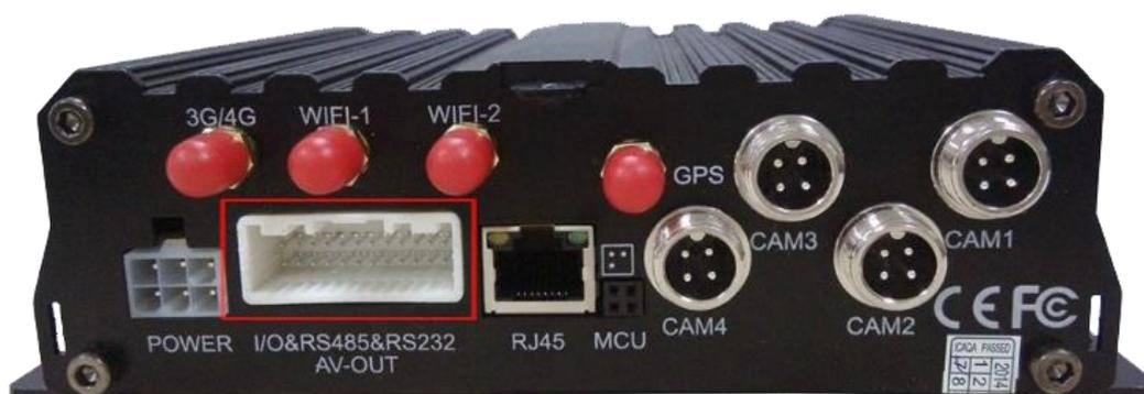
Esse conector é utilizado para conectar sensores, alarmes e dispositivos I/O no MDVR. Além disso, ele possui uma saída de alimentação, comunicação RS-485 e RS-232. A figura abaixo mostra a disposição dos cabos, porém, o chicote vem com a identificação de cada entrada ou saída.
